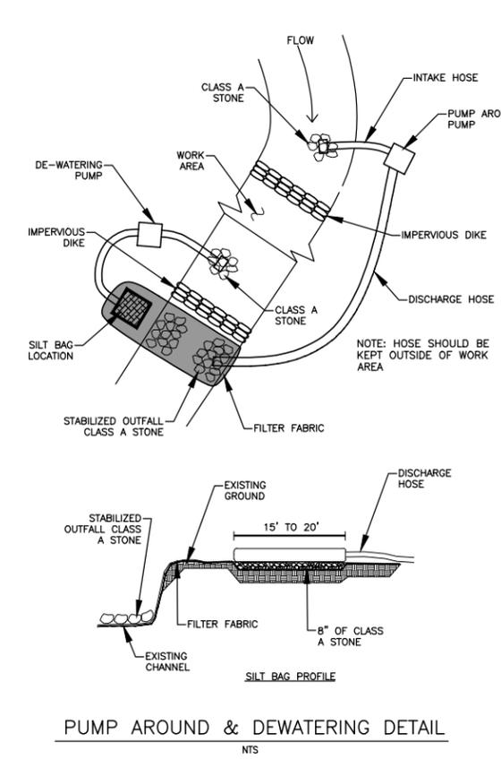
**PUMP AROUND & DEWATERING DETAIL**
