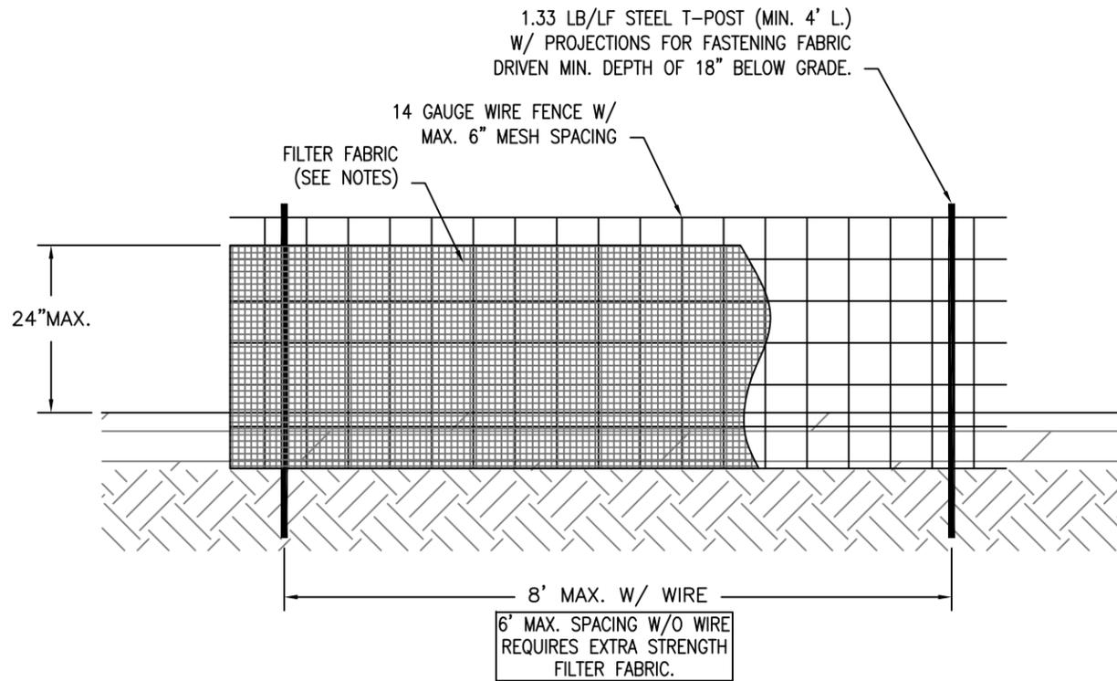
FILTER FABRIC SECURED ALONG UPSLOPE SIDE
